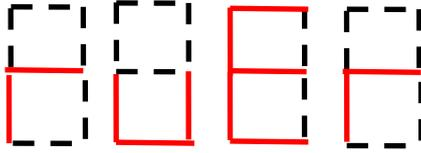
在 EtherCAT 模式下前两位数码管表示总线的通讯状态，后两位数码管表示的 EtherCAT 通讯错误警告指示。如果使能断线保护功能（F953=1 或 F953=2）时，当从站与主站建立连接后再断线，LED 数码管会显示“EthC”闪烁界面，表示从站已经与主站断线。在 EtherCAT 模式初始化状态下，LED 数码管会显示“E1n1”界面。
