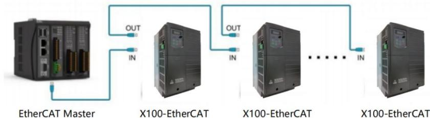
图 7-1 EtherCAT 组网连线图
