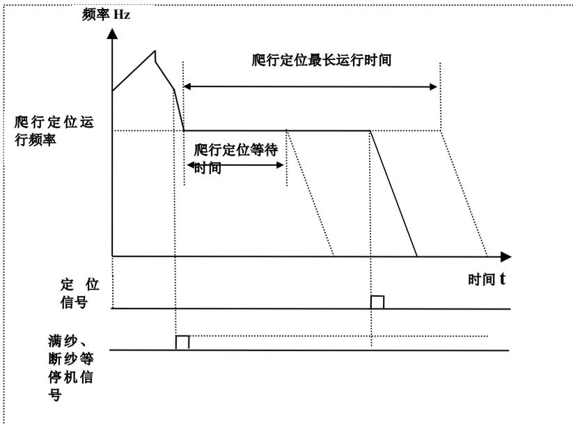
图 6-8 爬行定位工作模式示意图
