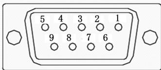
图 4-7 旋转变压器编码器端子排列示意图
