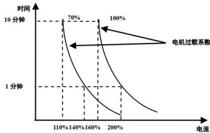
图 6-20 电机过载系数设定
