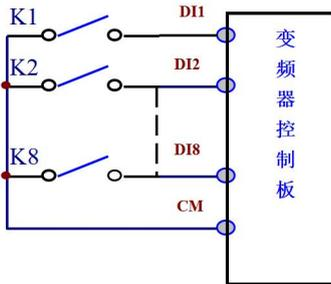
图 4-8 无源共源极接线方式示意图
