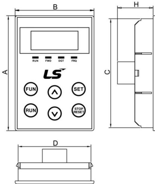
图 3-2 控制面板结构示意图
