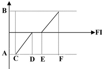
图 6-16 脉冲输入与设定量的计算关系
