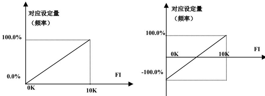
图 6-15 脉冲输入与设定量的对应关系
