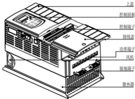
图 2-3 产品外形及结构部件图
