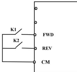
2: 两线式 2: 应用该模式时，FWD 为使能端子，方向由 REV 的状态来确定。
