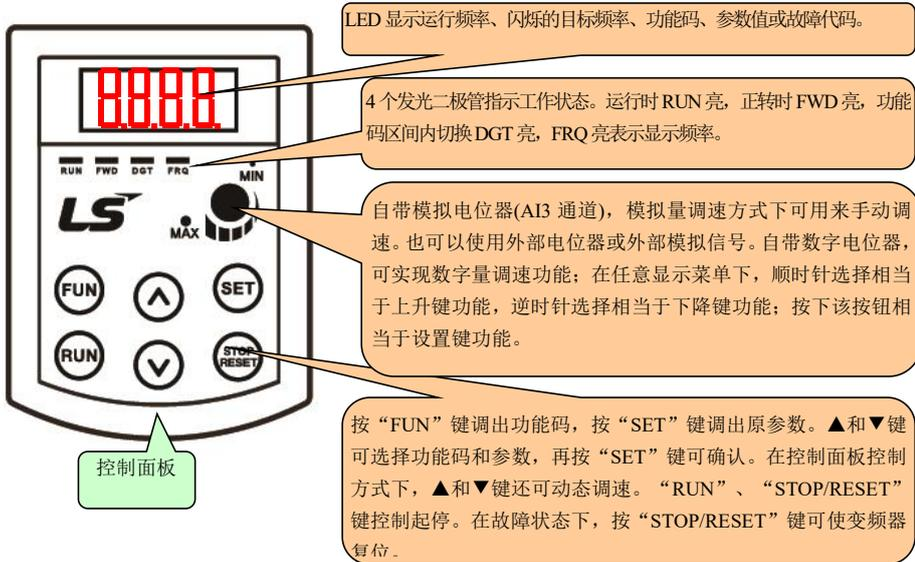
图 3-1 控制面板示意图
