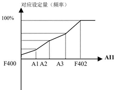
图 6-17 折线式模拟量输入与设定量关系
