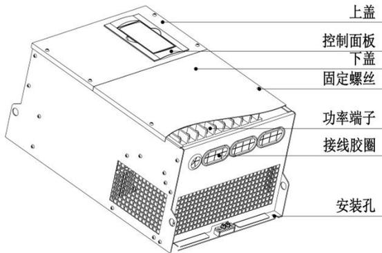
图 2-4 产品外形及结构部件图
