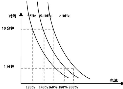
图 6-21 不同频率下的电机过载保护值
