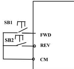
注: SB1 脉冲触发正转运行, 再次脉冲触发停止运行;
