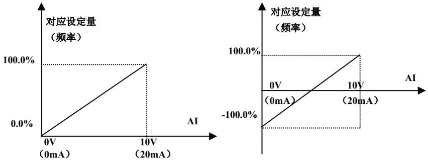
图 6-13 模拟给定与设定量的对应关系
