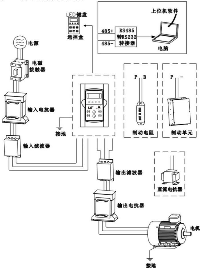
注意：55kW 以上机型内置直流电抗器。
