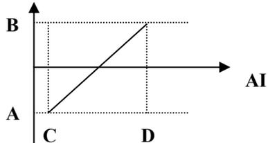
图 6-14 模拟给定与设定量的计算关系
