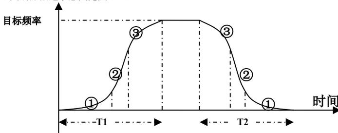
图 6-9 S 曲线加减速示意图
