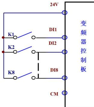
图 4-10 无源共漏极接线方式示意图
