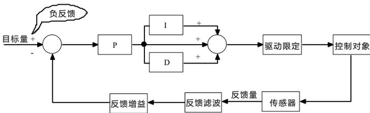
图 6-24 PID 控制算法示意图
